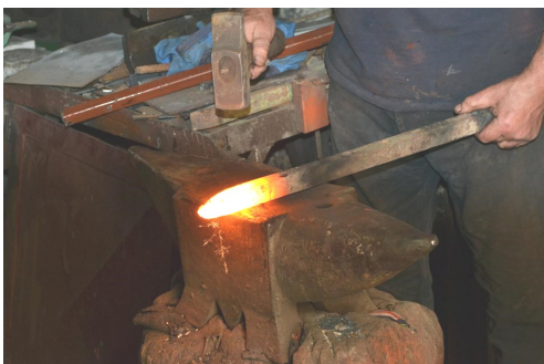
Esempio di lavorazione del ferro su incudine
